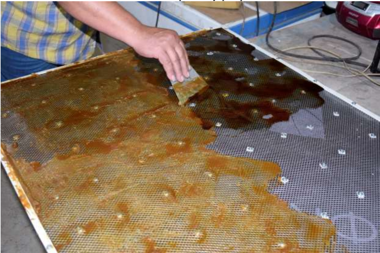
Клеящий состав – расплав смеси воска и канифоли
