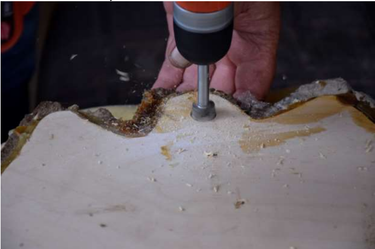
Сверление отверстий в дополнительной подложке для заполнения полостей
