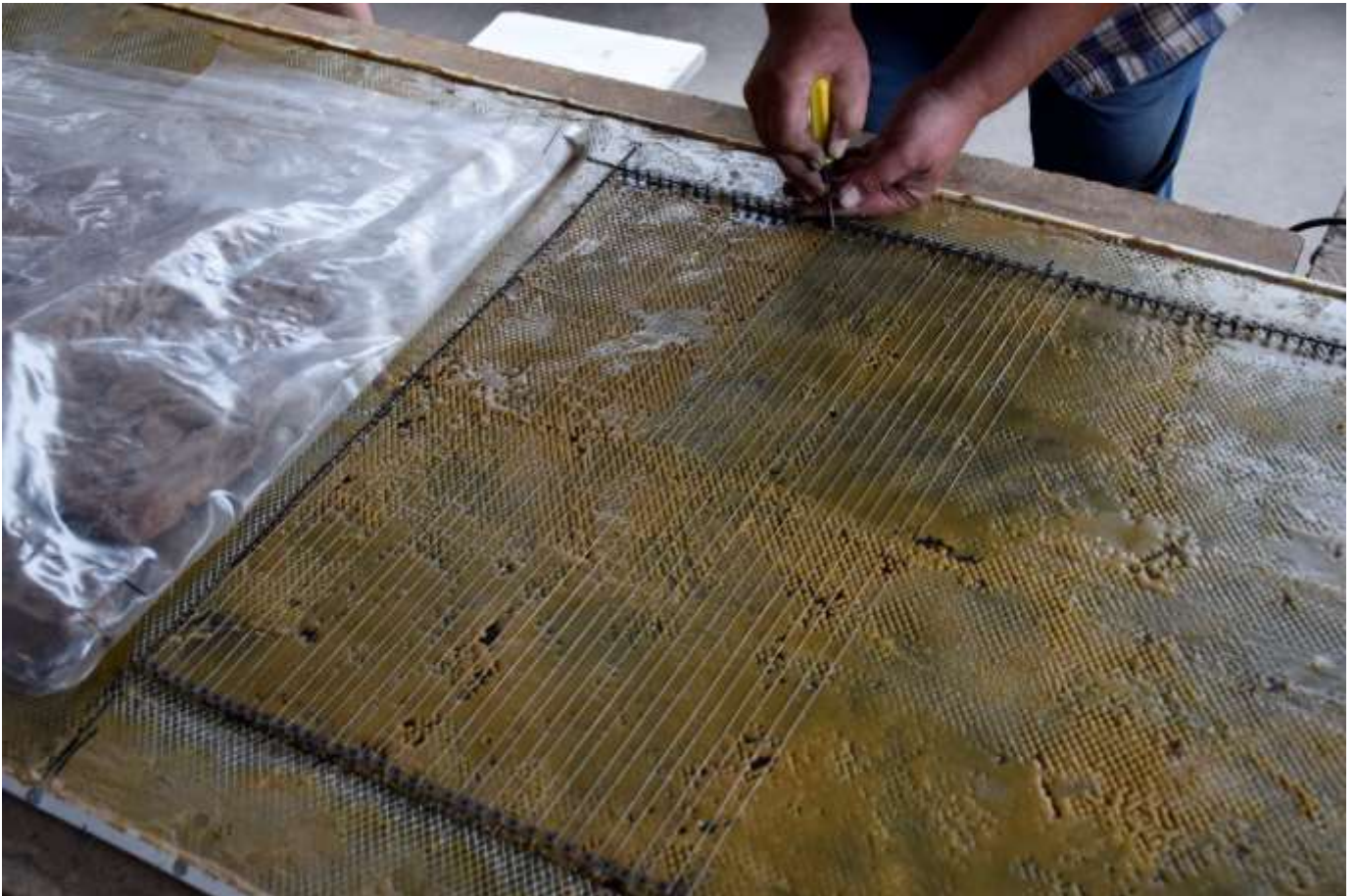
Подготовка нового основания для крупных фрагментов: установка нихромовой спирали вместо металлической сетки
