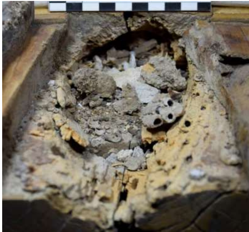
Содержимое полости: гнездо из глины, труха и сколы дерева, грязь
